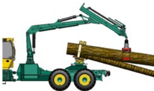
Langholzurückung mit schnell- wechselbarer Klemmbank
