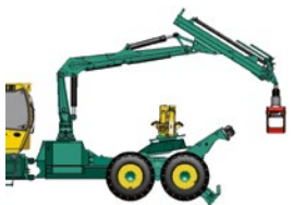
Seilrückung möglich ohne Umbau der Klemmbank
