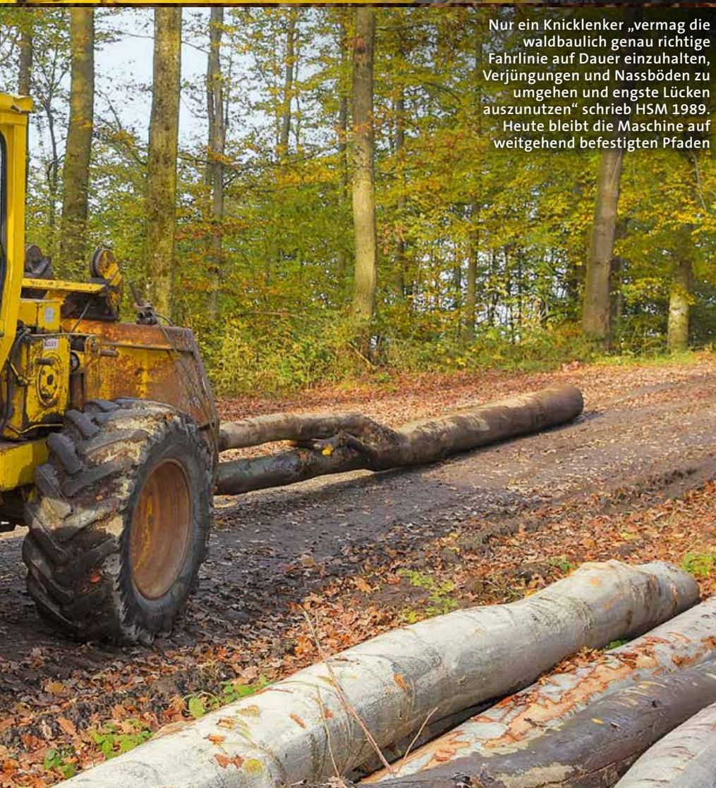
Nur ein Knicklenker „vermag die waldbaulich genau richtige Fahrlinie auf Dauer einzuhalten, Verjüngungen und Nassböden zu umgehen und engste Lücken auszunutzen“ schrieb HSM 1989. Heute bleibt die Maschine auf weitgehend befestigten Pfaden
