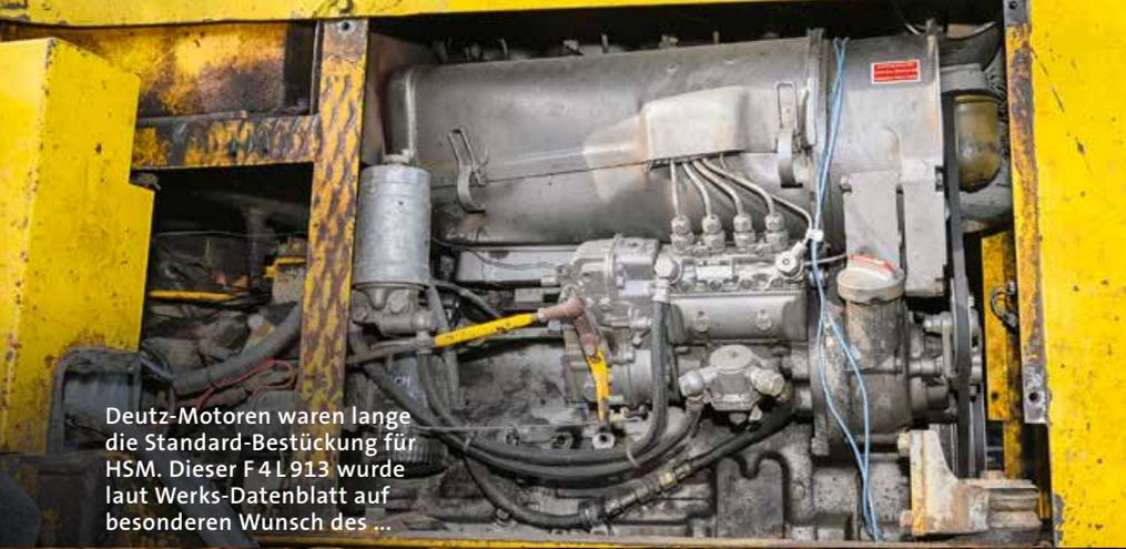
Deutz-Motoren waren lange die Standard-Bestückung für HSM. Dieser F4L913 wurde laut Werks-Datenblatt auf besonderen Wunsch des ...
