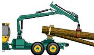
Langholzrückung mit schnellwechselbarer Klemmbank
