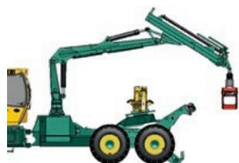
Seilrückung möglich ohne Umbau der Klemmbank
