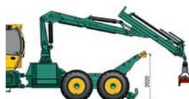
Châssis porte-poulies mobile avec une hauteur de sortie de câbles à 2,0 m
