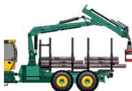
Double rancher central à démontage rapide pour billons de 2 x 2 m ou 2 x 2,5 m (n'existe pas pour la version courte de 805F)
