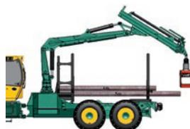
Dernier rancher démontable en position « centrale »
